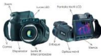
Fig. 7. Cámara de alta definición, ergonómica y con múltiples prestaciones (Guía de Termografía infrarroja, AETIR, 2004/2012)
