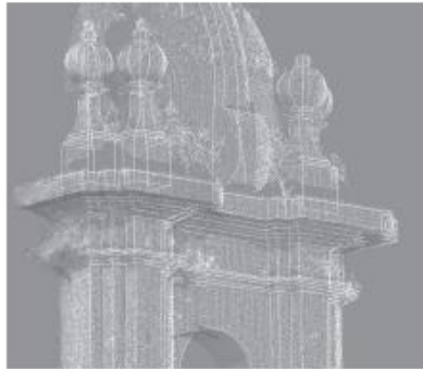
Fig. 5. Dibujo en AutoCad con el programa Cloudworx de los volúmenes generales de una estructura sobre una nube de puntos visualizada a baja densidad (Mañana P. et al. , 2008).
